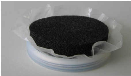
Cambio de membrana - colocar la membrana
