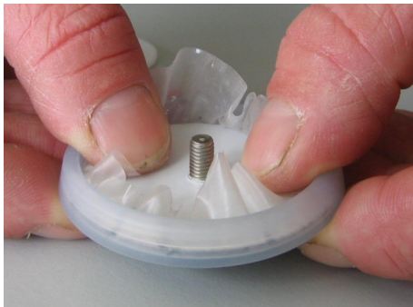
Cambio de membrana - encajar la placa del oscilador
